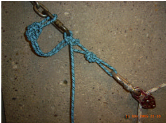
Poulie largable verrouillée avec nœud de mule et nœud simple (on peut aussi faire une demi clé sous le nœud de mule).
