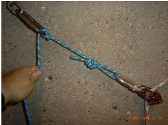
Largage de la poulie grâce au nœud italien.
