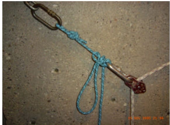
Poulie largable verrouillée avec nœud de mule (on peut aussi ajouter un nœud simple ou une demi clé).
